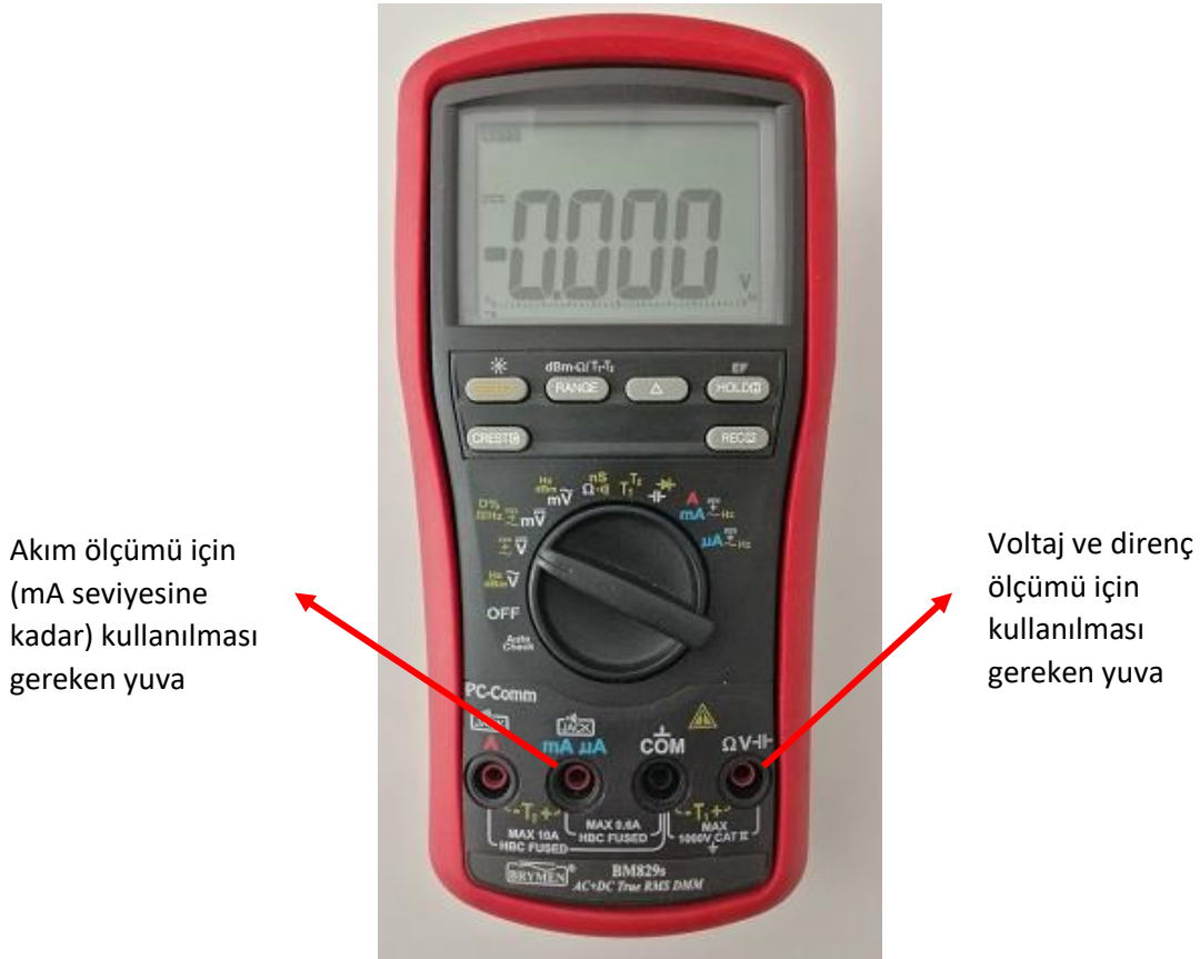
Şekil 4. Akım ölçümü için kırmızı probun bağlanması gereken yuva.
