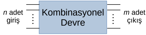
Şekil 1: Kombinasyonel (Bileşimsel) devrelerin blok diyagramı.
